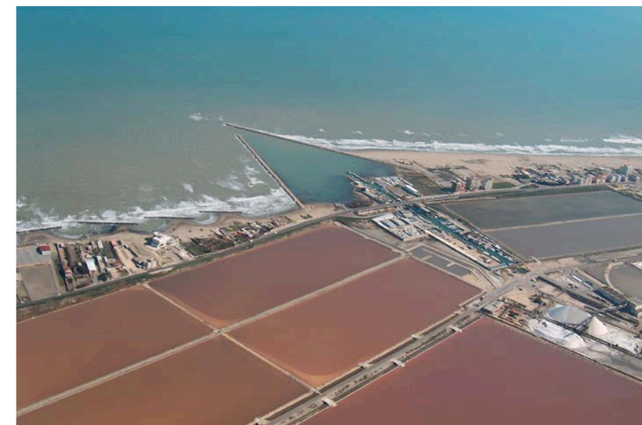
Porto di Margherita di Savoia, l'arenile formatosi a ridosso del molo di levante in seguito all'accumulo dei sedimenti trasportati verso nord dalle correnti litoranee
